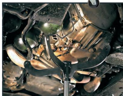
Adaptateur rotatif de boîtes de vitesses de grande taille, améliore l'accessibilité quand il est utilisé pour d'autres tâches. Points de montage pratiques.
