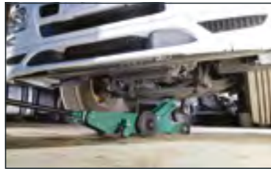
La longue portée du châssis facilite l'accès aux points de levage éloignés sous des camions et autobus.
