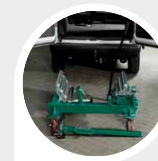
Manipulation facile de roues de grande dimension avec un diamètre compris entre 1250 mm et 2400 mm et de roues de grande largeur jusqu'à 1050 mm.
