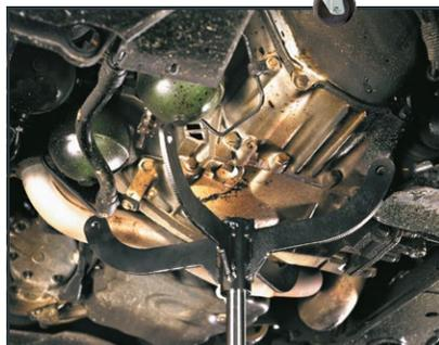
Adaptateur rotatif de boîtes de vitesses de grande taille, améliore l'accessibilité quand il est utilisé pour d'autres tâches.
